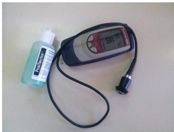
Obrázek 16 Ultrazvukový měřič tloušťky nánosu PosiTector 200 (Foto: autor)
