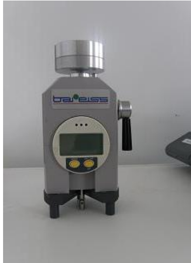
Obrázek 13 Přístroj Buchholz (Foto autor)
