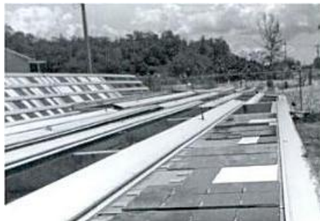
Obrázek 10 Konvenční vystavení vzorků povětrnostním vlivům (Zdroj: Schulz, U. 2009)
