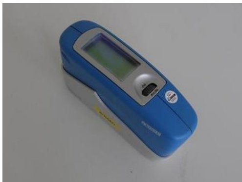
Obrázek 12 Leskoměr (Foto autor)
