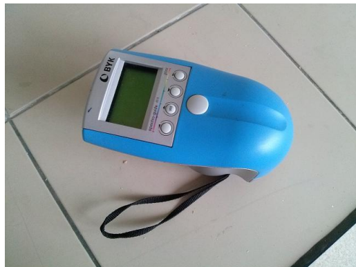
Obrázek 14 Spektrofotometr (Foto: autor)
