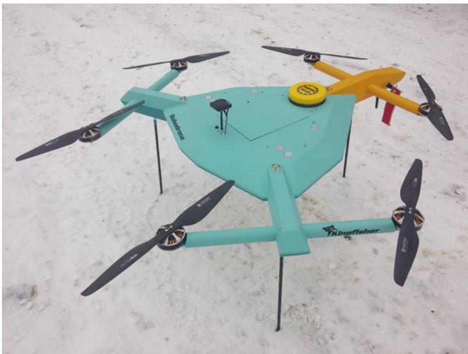
Obrázek 4: Hexakoptéra Robodrone Kingfisher – pohled shora.
