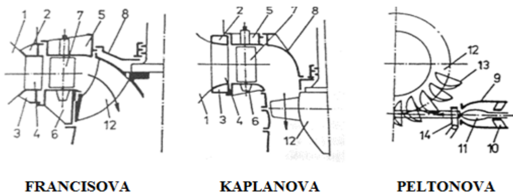
Obrázek 9 - Schéma řešení a hlavní části vodní turbíny [13]
