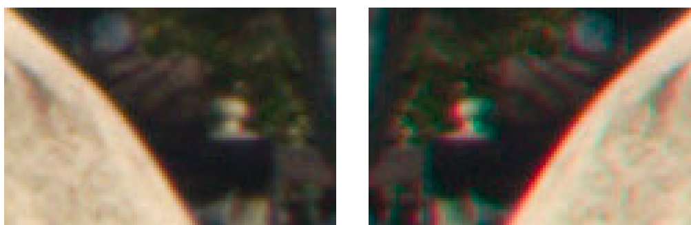
Obrázek 3.8: Srovnání snímku s chromatickou aberací (vpravo) a bez chromatické aberace (vlevo).[11]
