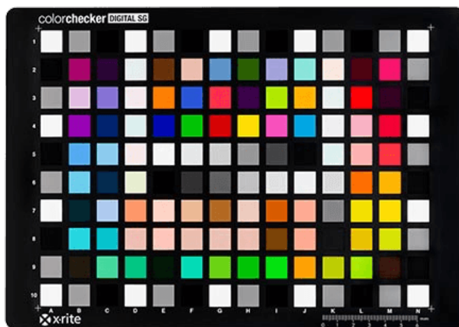
Obrázek 3.11: Standardní kalibrační terč se 140 poli, který se používá i v interním procesu tvorby DCP profilů pro Zoner Photo Studio X. Tržní cena těchto terčů je okolo 370 amerických dolarů.
