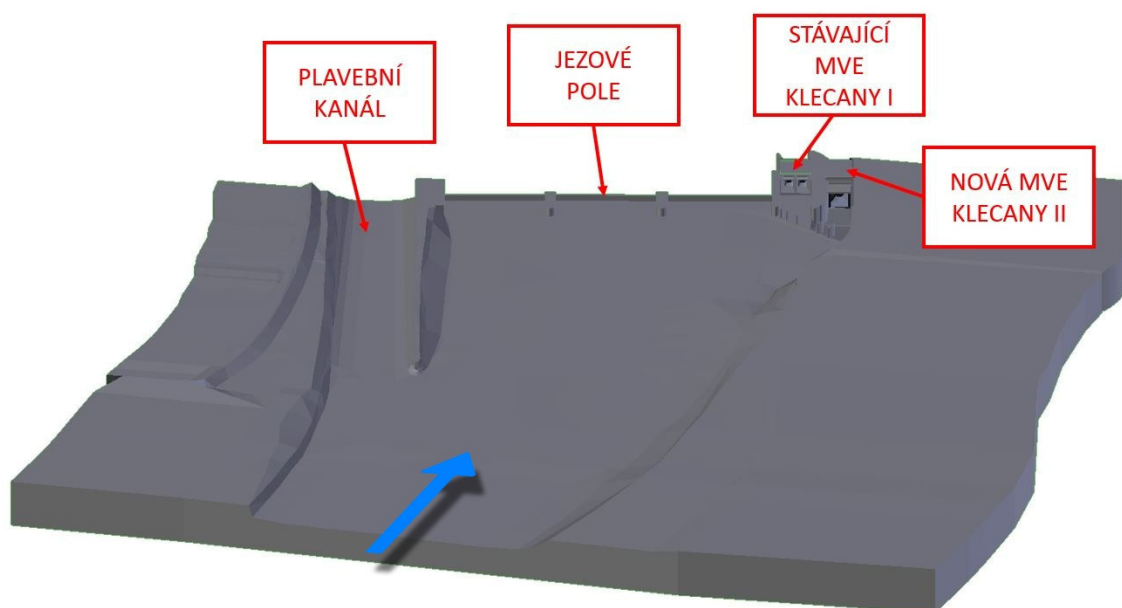
Obrázek 18 - Vytvořený výpočtový model s novou MVE Klecany II
