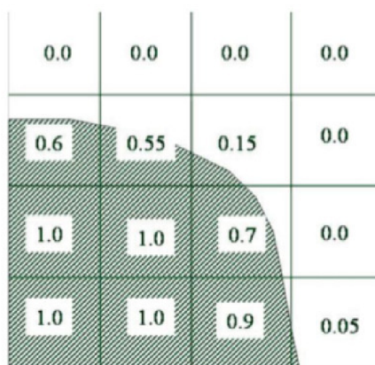
Obrázek 3 - Hodnoty objemové frakce vody při použití VOF (volná hladina) [D14]
