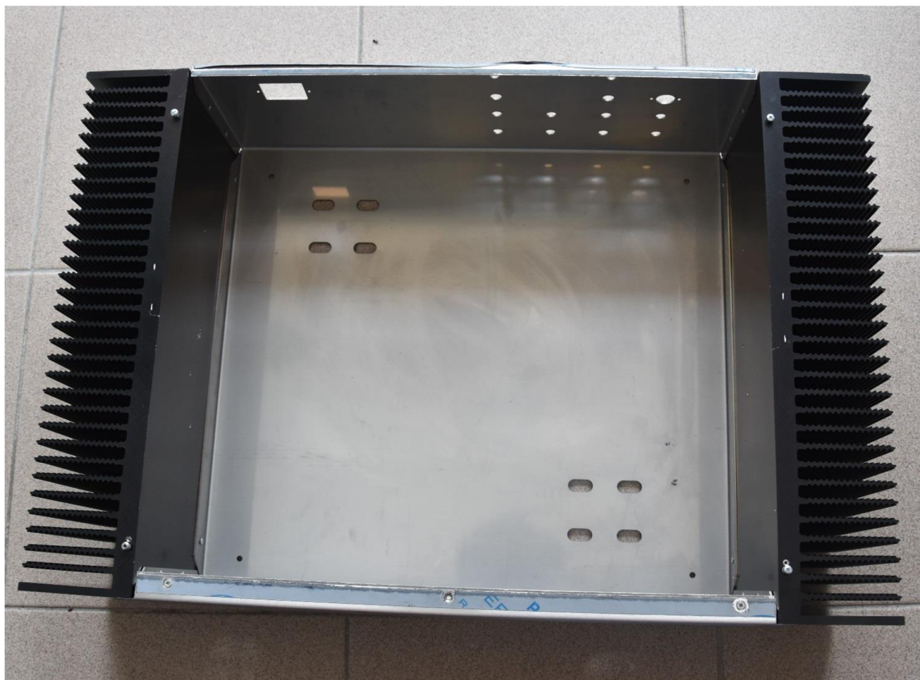
Příloha 37 – Vnitřní pohled do skříně zesilovače
