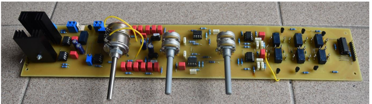
Příloha 36 – Fotografie (zprava) přepínače vstupů, předzesilovače a sluchátkového zesilovače
