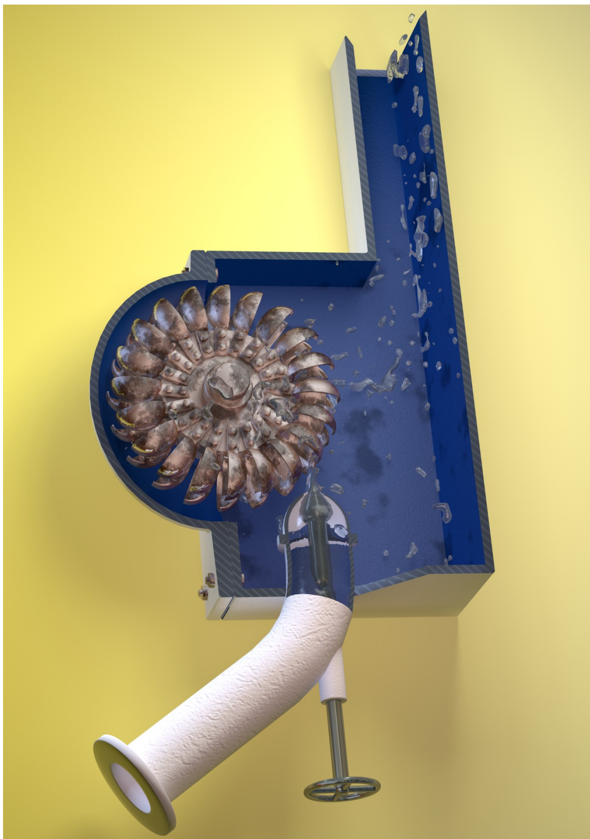
Obr. 21 - Finální výstup vizualizace řezu Peltonovou turbínou (Zdroj: vlastní tvorba)
