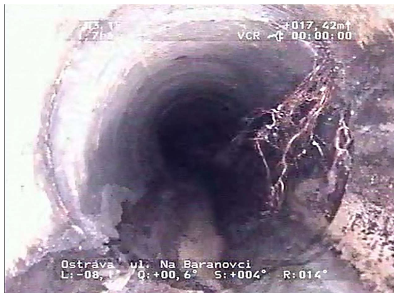
Obr. 21 Prorůstající kořeny na úseku u25 [OVAK a.s.]
