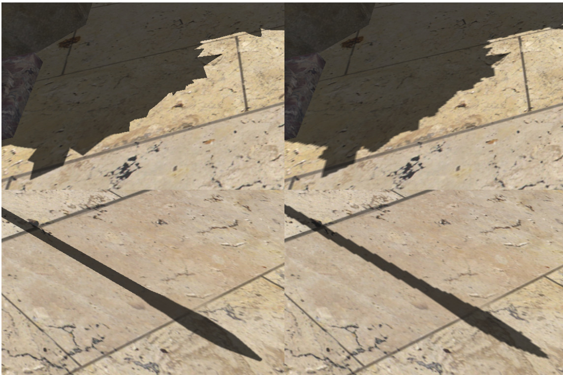
Obrázek 6.12: Srovnání tvrdých stínů při použití hybridního sledování paprsků ( vlevo ) a rasterizace ( vpravo ). Doba výpočtu na GPU se u obou případů pohybuje okolo 1ms .
