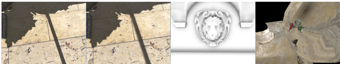
Obrázek 5.9: Ukázka implementovaných hybridních efektů – tvrdé stíny ( první ), měkké stíny ( druhý ), ambient occlusion ( třetí ) a odrazy ( čtvrtý ).
