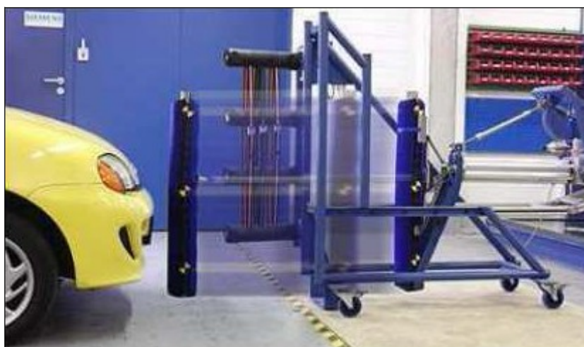
Obr. 6 – Provedení testu s jednotlivými impaktory [1]
