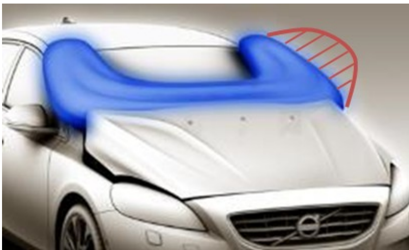
Obr. 39 – Vlastní návrh rozšířeného airbagu [11], [3]
