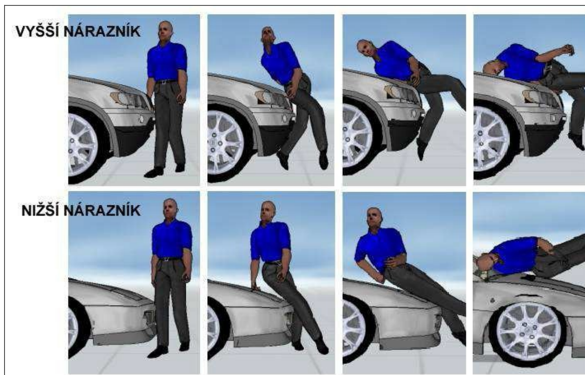
Obr. 9 – Více polohová simulace střetu vozidla – chodec [6]
