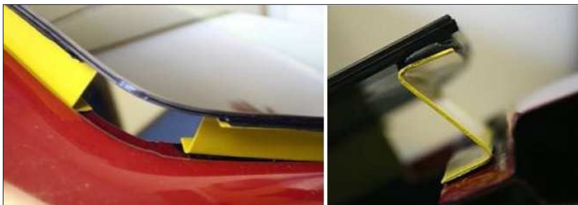
Obr. 13 – Systém uchycení čelního skla absorbujícího energii při nárazu [8]
