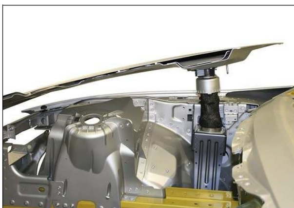
Obr. 15 – Systém aktivní kapoty firmy Jaguar, zdvihací mechanismus [9]
