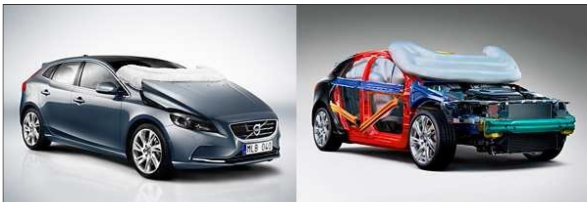
Obr. 18 – Systém airbagu pro chodce Volvo V40 [11]
