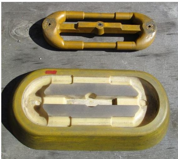
Obr.3-2: Dřevěný model pro výrobu zkušebních vzorků [25]
