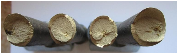
Obr. 3-21: Makrostruktura provozních vzorků (označených A-E), (horní bez TZ, dolní s TZ) [25]
