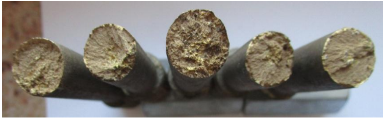
Obr. 3-23: Makrostruktura vzorků Experimentálních vzorků (označených 2-6) po prvním přidání AlSr10 (789g),(horní bez TZ, dolní s TZ) [25]
