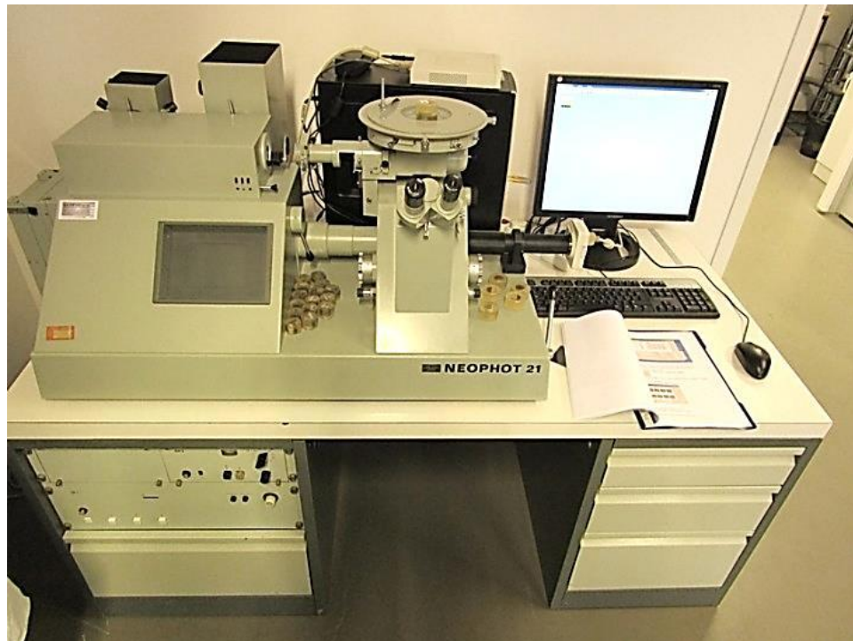
Obr. 3-14: NEOPHOT 21 – přístroj pro sledování struktruy
