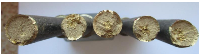
Obr. 3-22: Makrostruktura vzorků Experimentálních vzorků (označených 2-6) po prvním přidání AlSr10 (789g), (horní bez TZ, dolní s TZ) [25]
