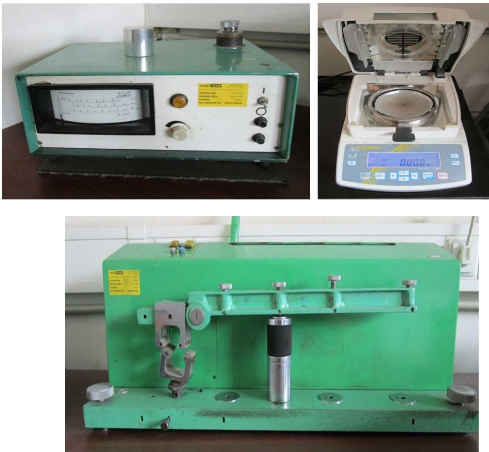
Obr. 3-4: Přístroje pro kontrolu formovací směsi (kontrola prodyšnosti – vlevo nahoře; kontrola vlhkosti – vpravo nahoře; kontrola pevnosti v tlaku – vlevo dole) [25]
