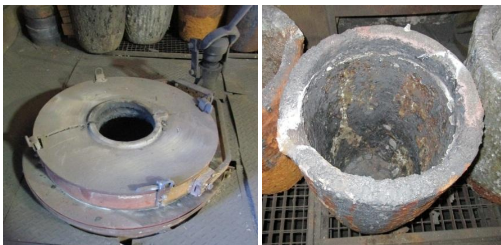
Obr. 3-5: Tavící pec (vlevo) a tavící kelímek (vpravo) pro Cu slitiny
