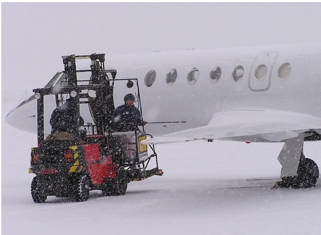
Obrázek 12: Vysokozdvížený vozík se soupravou na odmrazování
