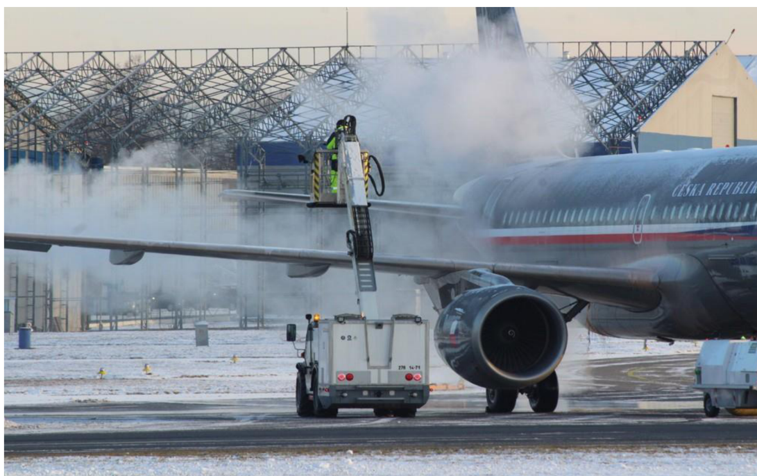
Obrázek 1: Proces odmrazování letadla
