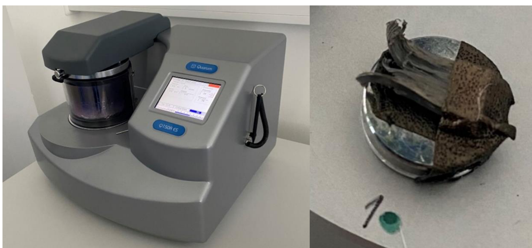
Obrázek 43 – Naprašovačka kovů Quorum Q150R ES (vlevo) a vzorek č.1 (vpravo)
