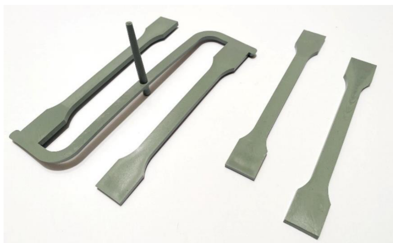
Obrázek 33 – Vzorky vyrobené metodou vstřikování
