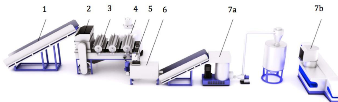
Obrázek 5 – Regramulační linka PE obalových materiálů
