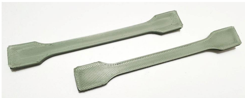
Obrázek 37 – Vzorky z LLDPE vyrobené metodou 3D tisku
