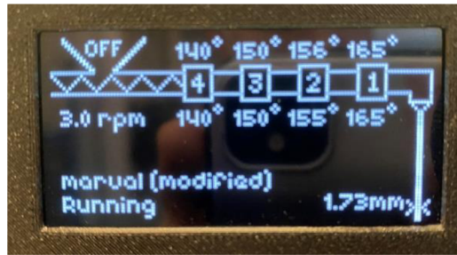
Obrázek 28 – Nastavené parametry na extruderu
