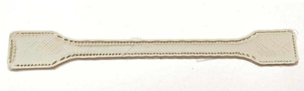
Obrázek 38 – Vzorek z LDPE vyrobené metodou 3D tisku
