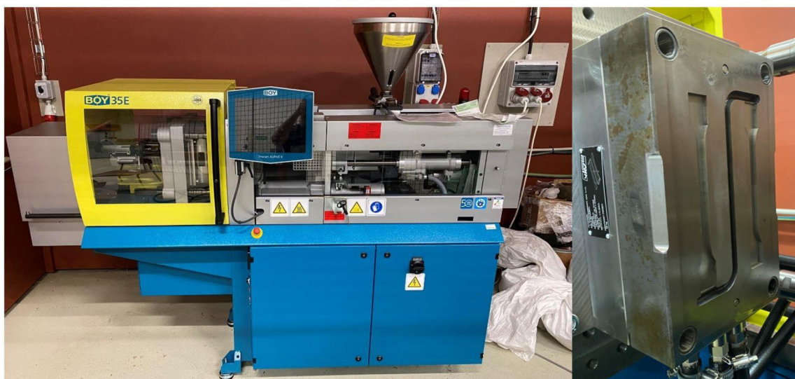
Obrázek 32 – Vstřikolis BOY 35 E a vstřikovací forma
