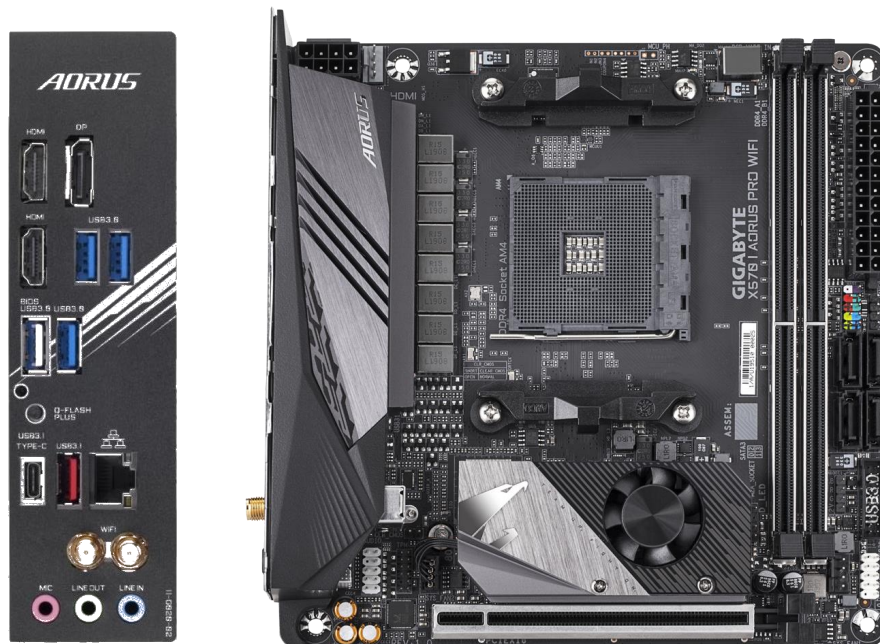
Obr. 4.1: Zobrazení vybrané mITX základní desky
