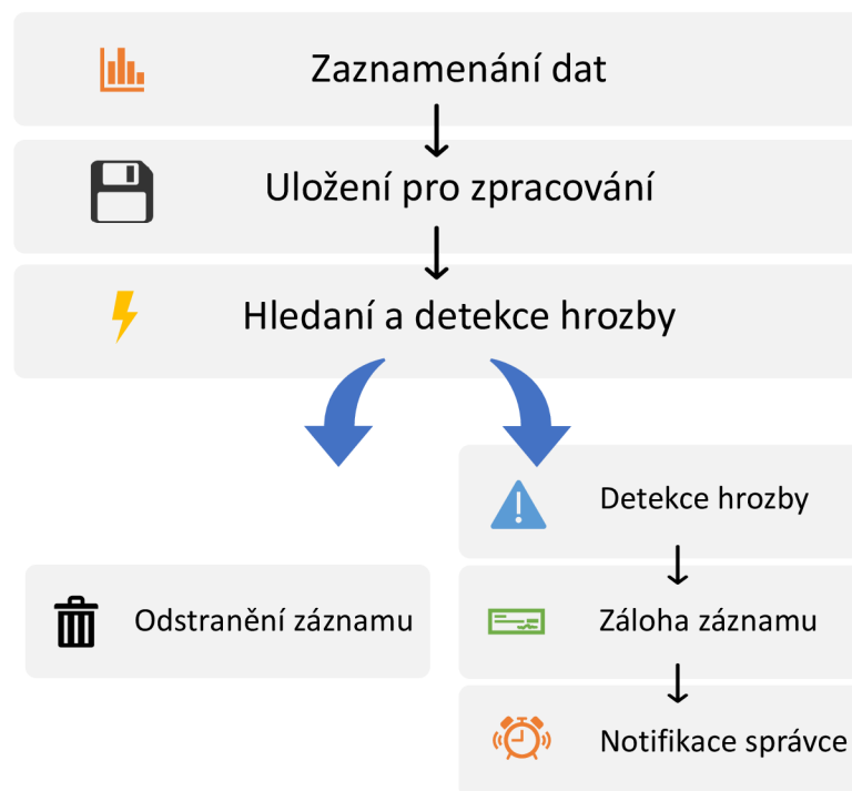
Obr. 6.2: Zjednodušené znázornění činnosti WiFi honeypotu realizované skripty
