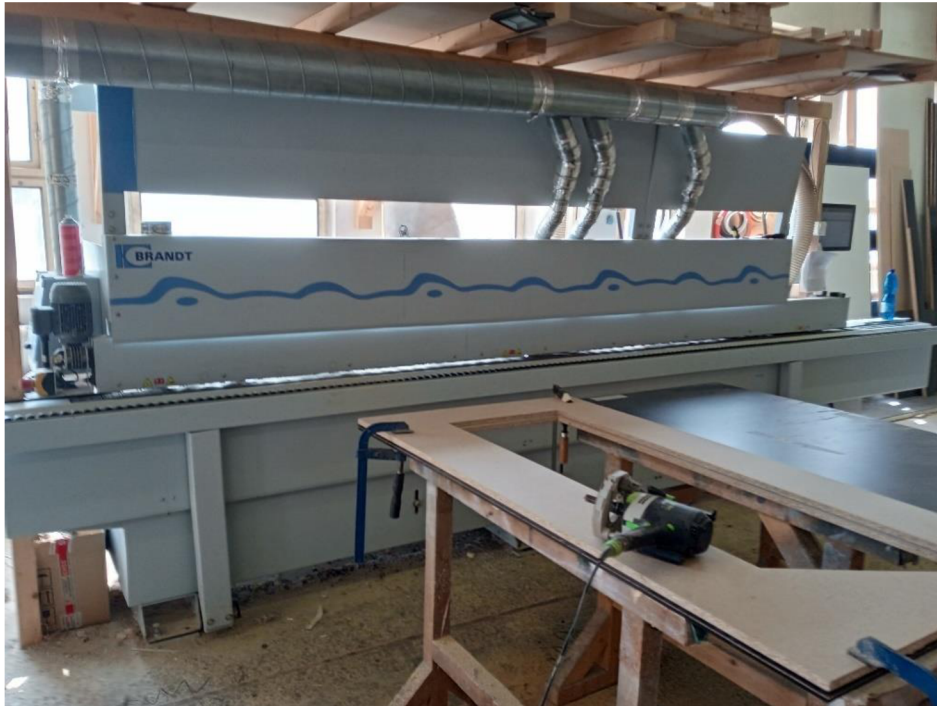
Obr. 55 Olepovací stroj Brandt KDF 440.
