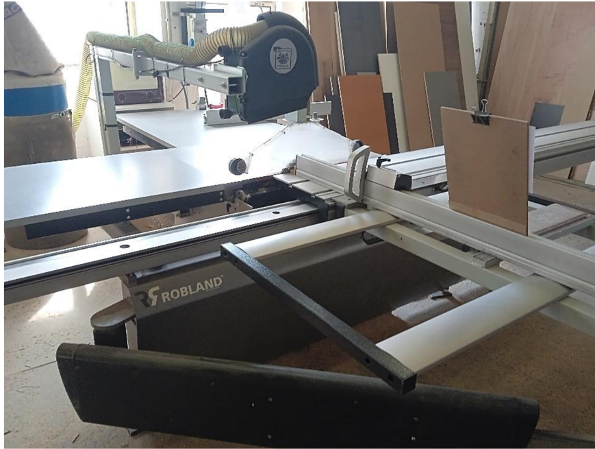
Obr. 53 Formátovací pila Robland Z 3200.
