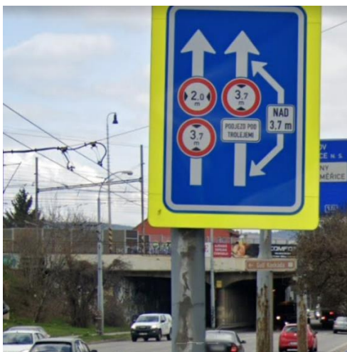
Obrázok 56 - Prejazd pod železničný most [3]
