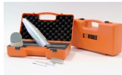
Obrázok 134 - Schmidtov odrazový tvrdomer [46]
