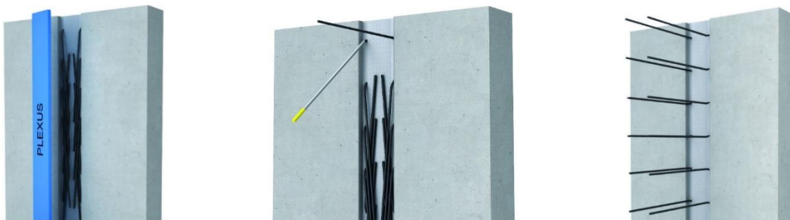
Obrázok 147 - Postup vylamovania výstuže [49]
