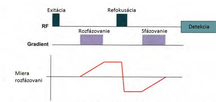
Obr. 2.3: Schéma PGSE sekvencie s vyznačenou mierou rozfázovania.[6]
