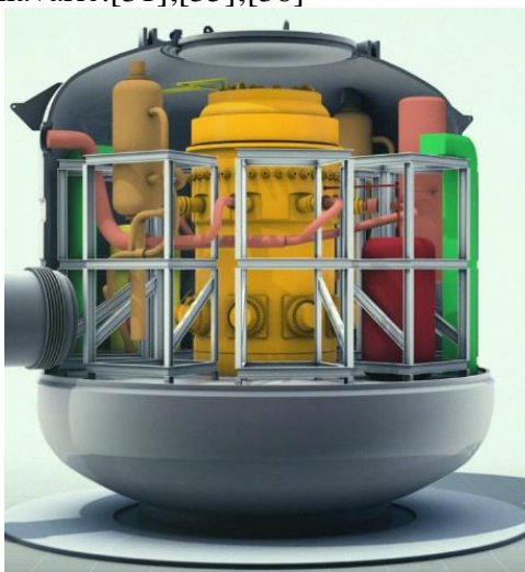
Obr. 25 Oceľový kontajment reaktoru NUWARD™ [36]
