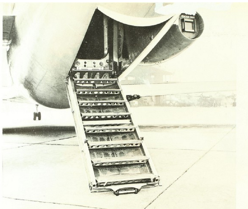
Obr. 9 Caravelle se sklopenou záďí se schody připravenými pro nástup cestujících [24]
