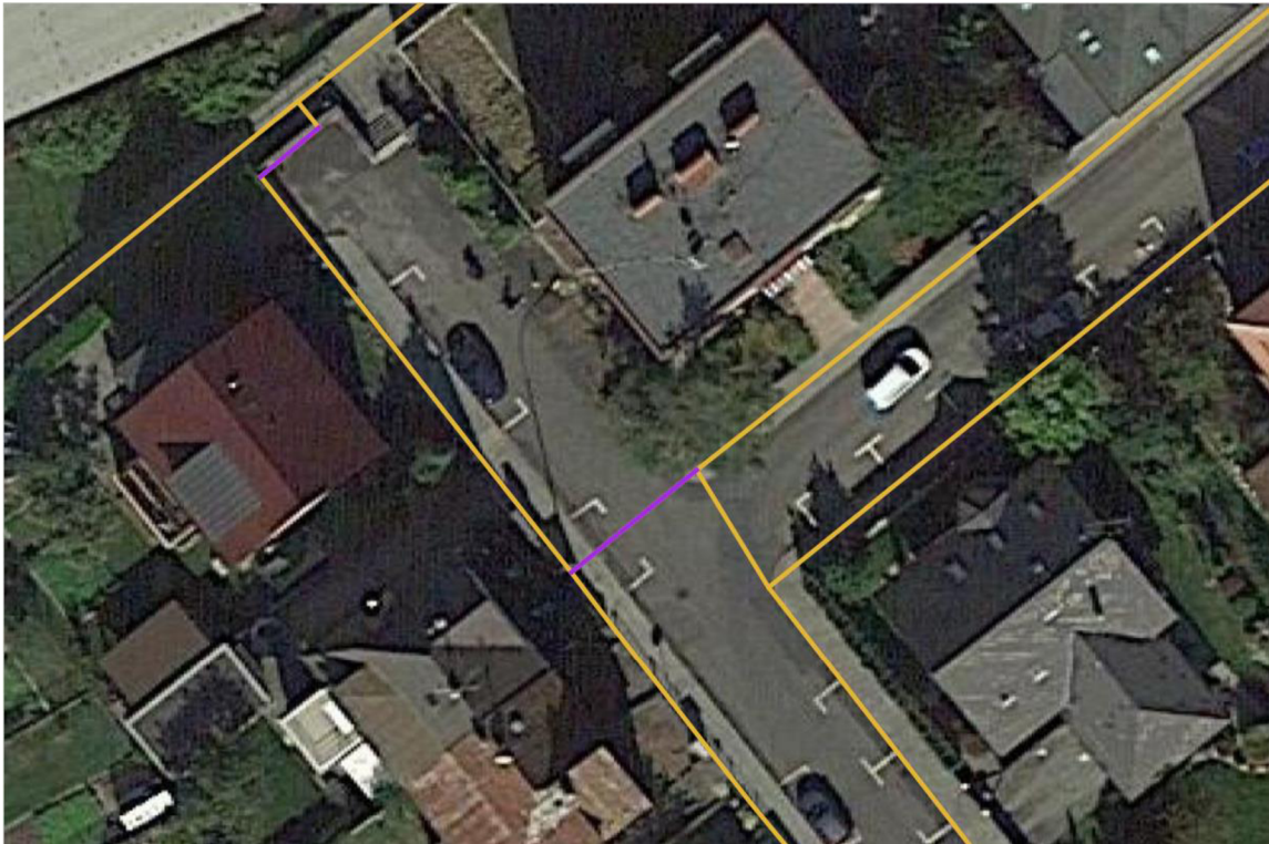
Obrázek 5: Propojování původní neupravené sítě chodníků (oranžová) novými prvky (fialová), zdroj: autor
