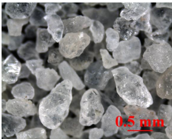
Obrázek 14: Křemičitý písek; tvar zrn podobný drcenému křemenci (12x zvětšeno)
