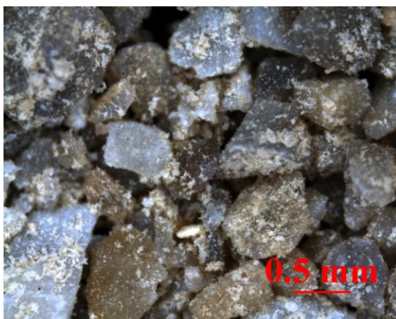
Obrázek 12: Křemence frakce 0 – 1mm; zřetelné prachové částice na povrchu zrn (12x zvětšeno)
