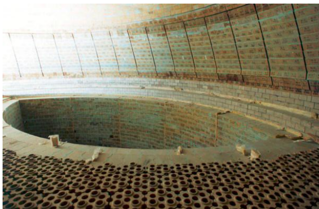
Obrázek 8: Vnitřní vyzdívka ohříváče větru [5]
