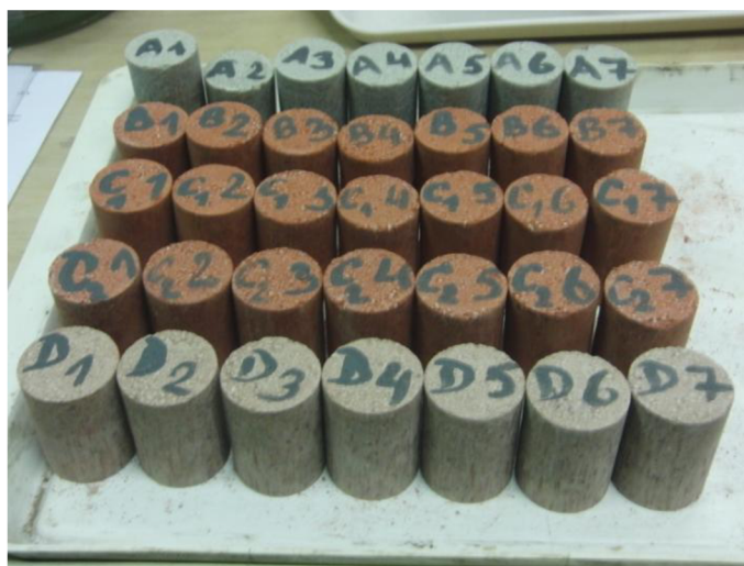
Obrázek 20: Zkušební tělesa po vylisování
