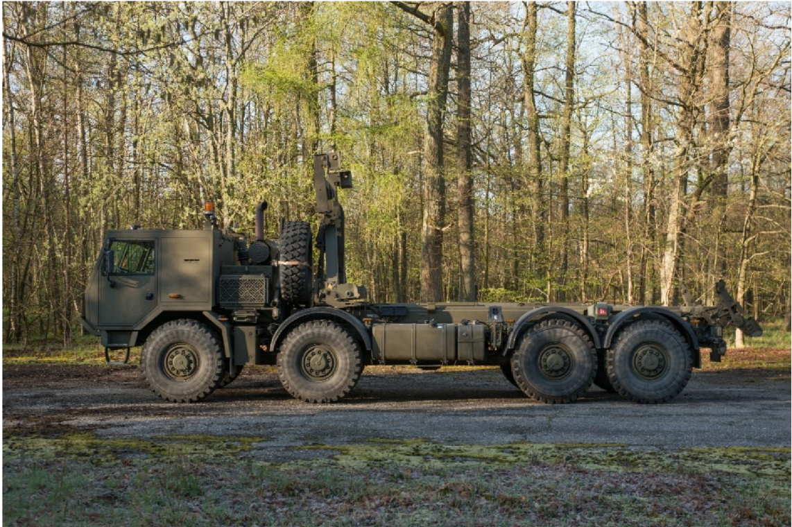
Obr. 3.6 T815-7 Force kontejnerový nakladač MSH
