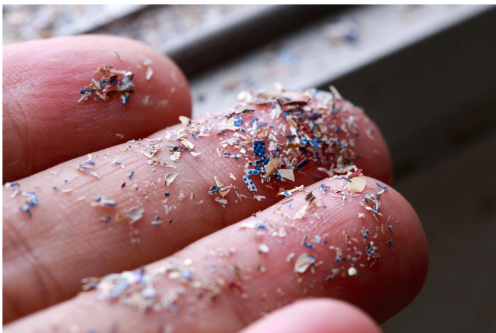
Obrázek 1 Sekundární mikroplasty. Převzato ze zdroje 9.
