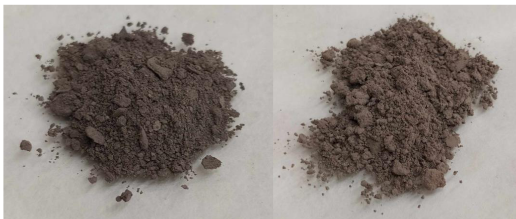
Obrázek 11 Připravené katalyzátory. Vlevo \text{ZnO}/\text{CoFe}_2\text{O}_4 , vpravo \text{TiO}_2/\text{CoFe}_2\text{O}_4 .
