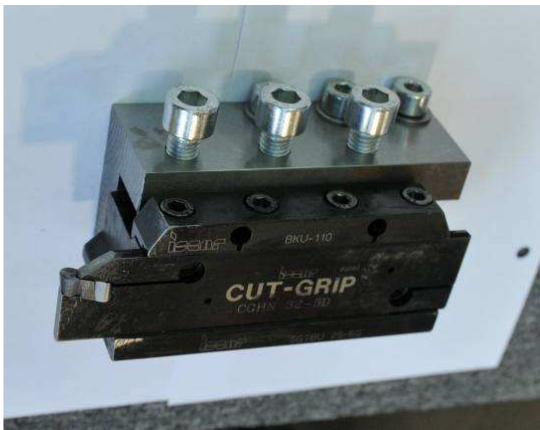
Obr. 4.6 Použitý nástroj s vyrobeným upínačem pro použití na soustruhu TOS Kuřim SU 50A
