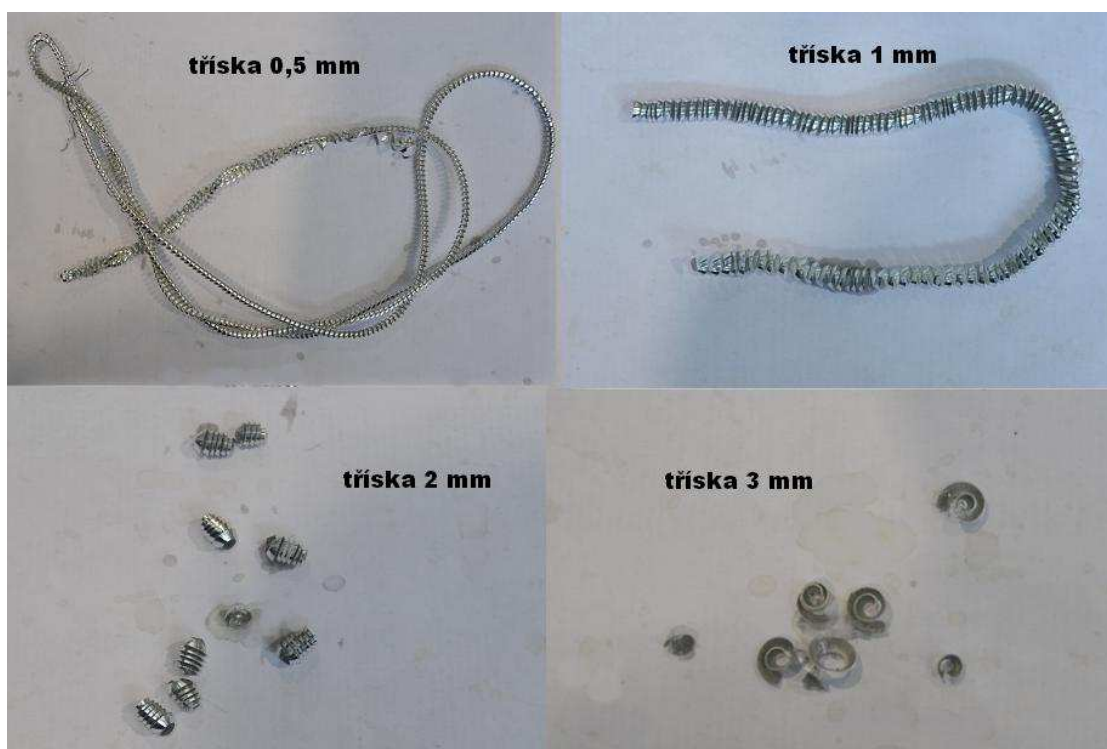
Obr. 4.26 Vzniklé třísky pro různé hodnoty hloubky řezu a_p
