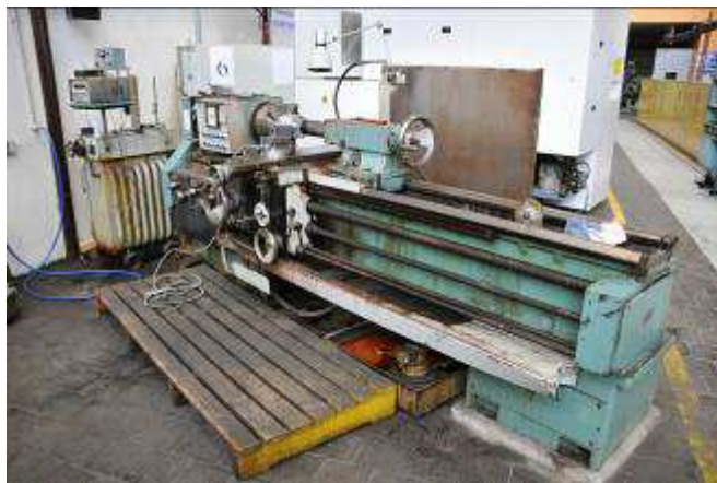
Obr. 4.2 Konvenční soustruh TOS Kuřim SU 50A
