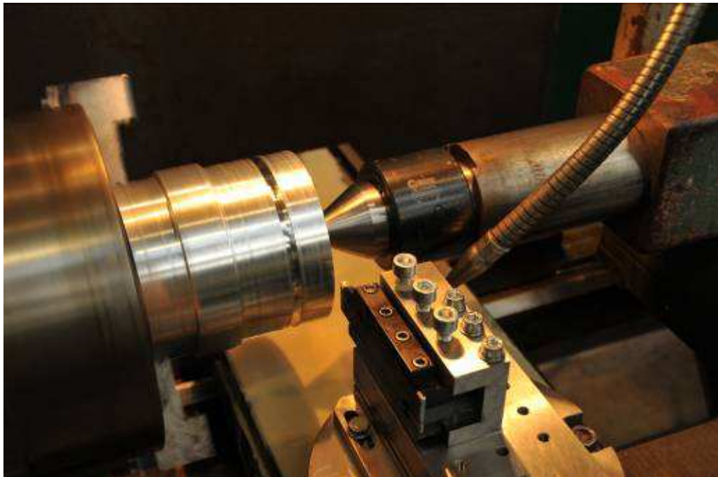
Obr. 4.1 Konfigurace během měření na konvenčním soustruhu
