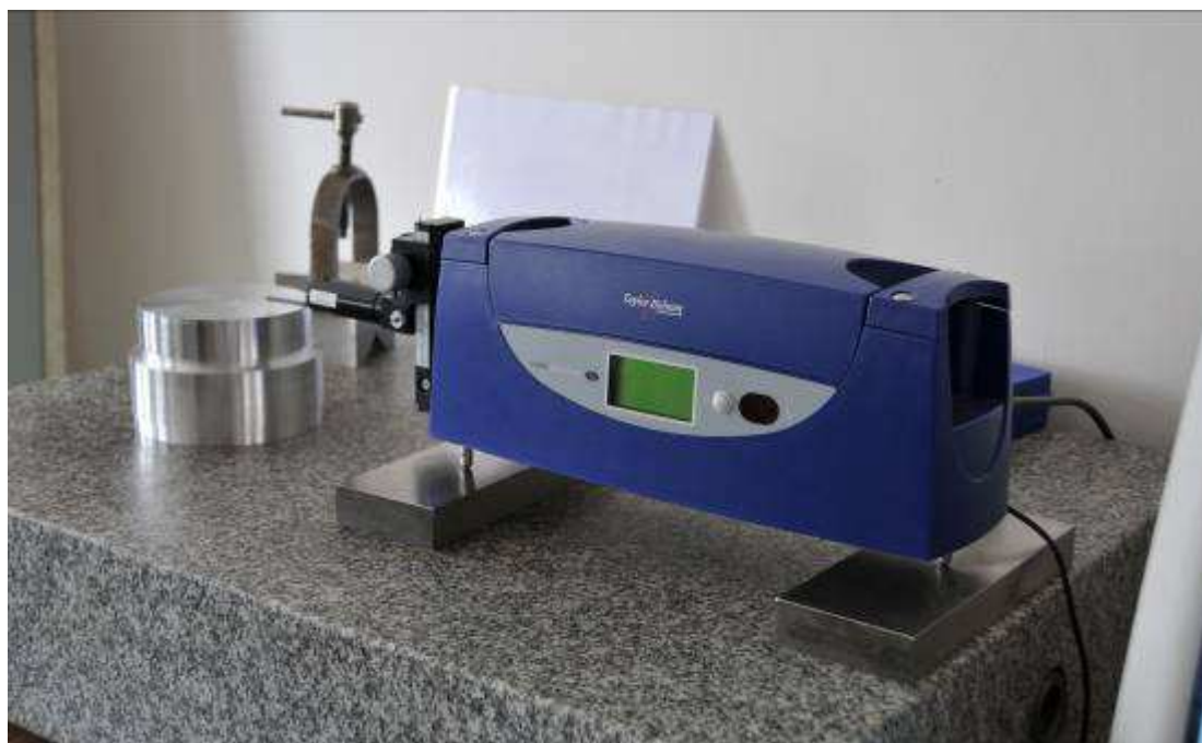
Obr. 4.29 Průběh měření pomocí přesného drsnoměru FORM TALYSURF 50
