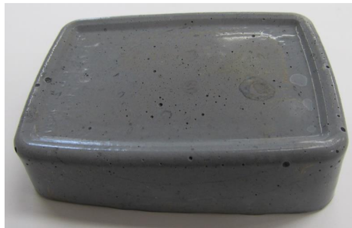
Obr.29 – Vzorek z třetí sady (s 5 hm. % popela)
