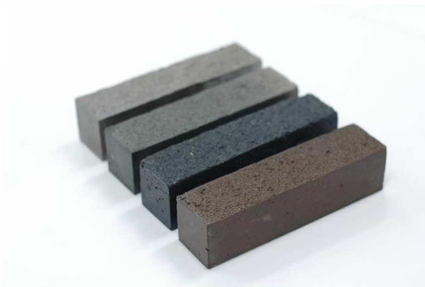
Obr. 23 – Různě zbarvené vzorky geopolymery [106]
