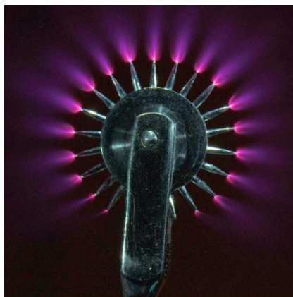
Obr. 13 – Koronový výboj na plazmovém kole [63]
