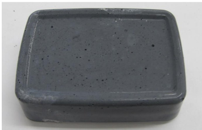
Obr.30 – Vzorek ze čtvrté sady (s 10 hm. % popela)
