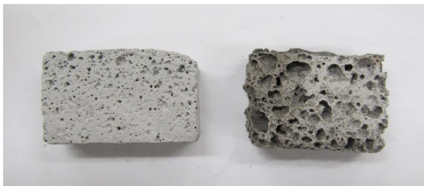
Obr. 31 – Porovnání vypěněného vzorku ze sodného (vlevo) a draselného Baucisu
