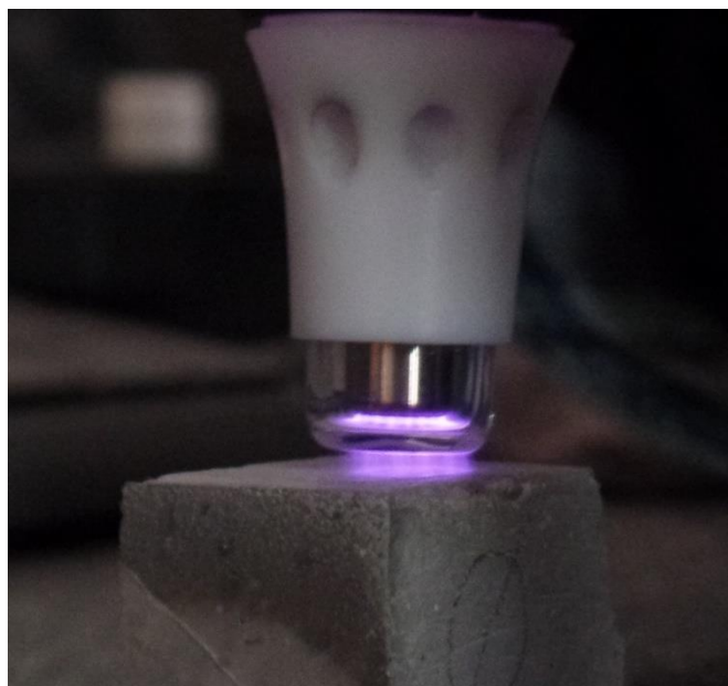
Obr. 33 – Povrchová úprava geopolymery (near-field nozzle)
