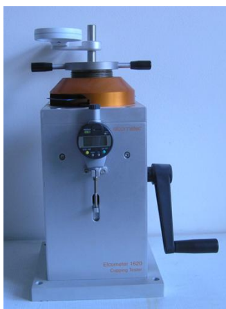
Obr. 28 Zkušební zařízení dle normy ČSN EN ISO 1520
