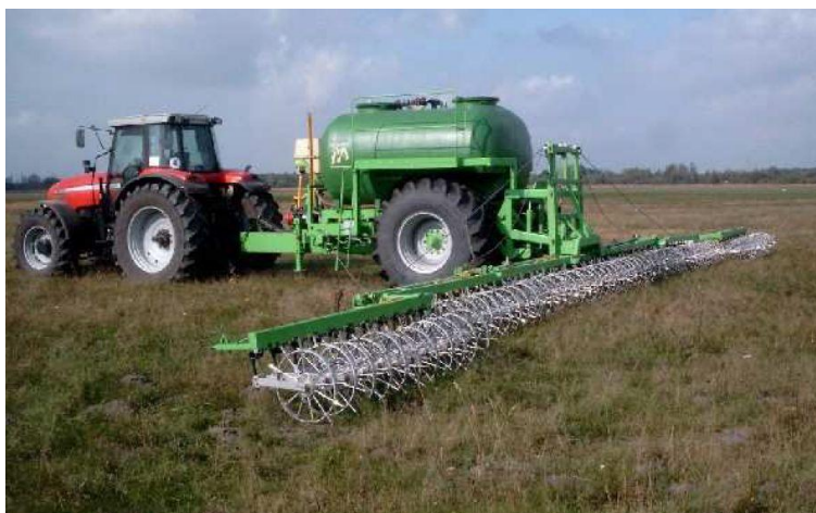
Obr. 11 Stroj pro hnojení tekutými prům. hnojivy injektáží do půdy (Fríd, 2012)
