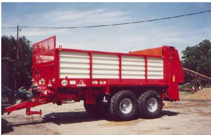
Obr. 2 Traktorové univerzální rozmetadlo hnoje a kompostů HTS (Frid, 2012)
