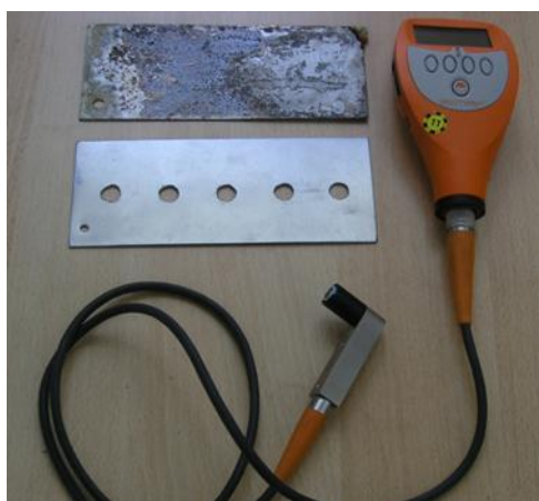
Obr. 30 Testovací sonda na úbytek zinkového povlaku
