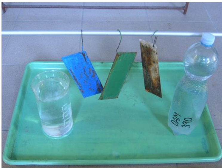
Obr. 33 Cyklická zkouška v kapalném hnojivu DAM 390
