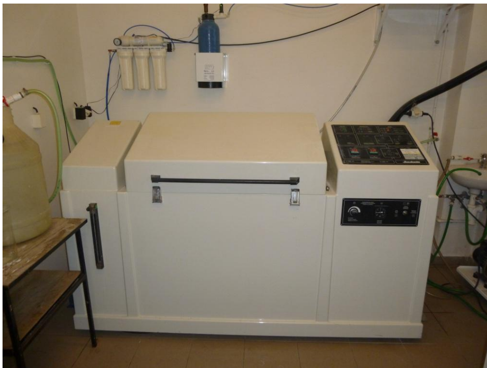
Obr. 36 Zkušební komora se solnou mlhou
