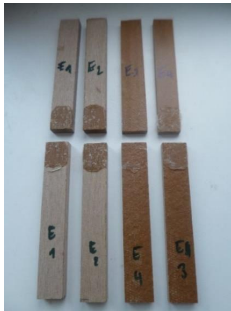
Obr. 28 Přetrhnuté zkušební vzorky lepené lepidlem Petec Kleben & Dichten ecoline
