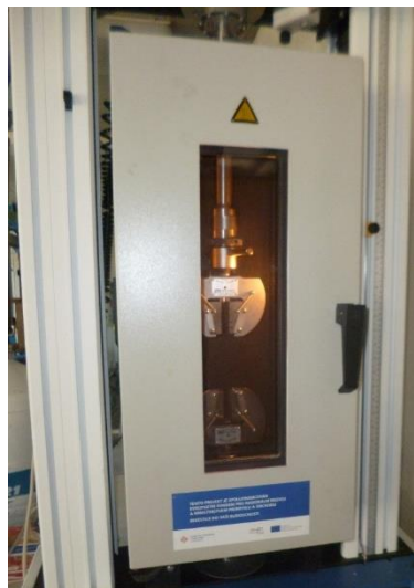
Obr. 36 Pohled na upínací čelisti uvnitř uzavřené komory
