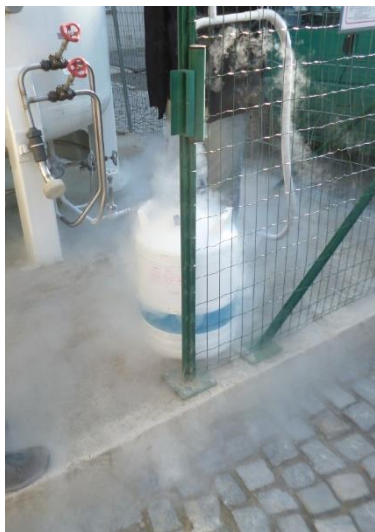
Obr. 35 Čerpání kapalného dusíku do bomby
