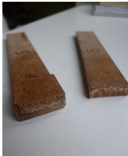
Obr. 24 Přetrhnutý svařený a označený zkušební vzorek z materiálu Resysta
