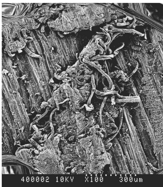
Obr. 16 Propletení ligninu s celulóзовými vlákny a buňkami (tracheidy) po svařování dřeva na 100 x zvětšeném snímku pořízeném elektronovým mikroskopem (Pizzi a kol., 2003)
