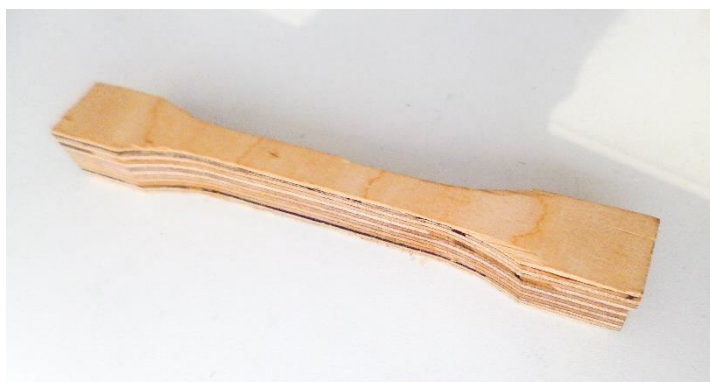
Obr. 29 Šablona z 18 mm tlusté plošné desky překližované (PDP) s výsledným tvarem a rozměry zkušební vzorku na zkoušku pevnosti materiálu
