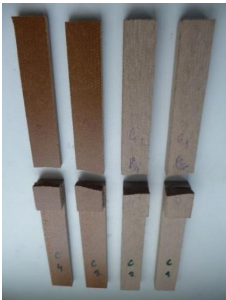
Obr. 27 Přetrhnuté zkušební vzorky lepené lepidlem Tangit PVC-U
