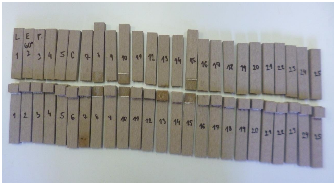
Obr. 34 Lepené vzorky po zkoušce pevnosti v tahu při 60 °C
