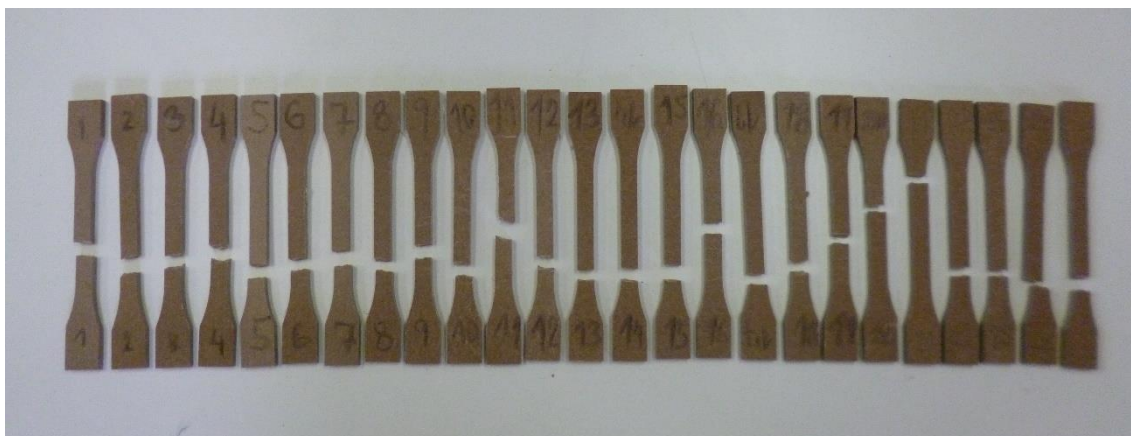
Obr. 64 Vzorky po zkoušce meze pevnosti materiálu Resysta v tahu při 60 °C
