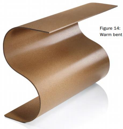
Obr. 7 Beztržiskové obrábění materiálu Resysta ohybem za tepla (SIMONA, 2016)
