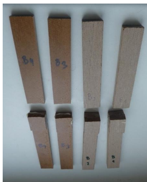
Obr. 26 Přetrhnuté zkušební vzorky lepené lepidlem Cosmo PU 180.120
