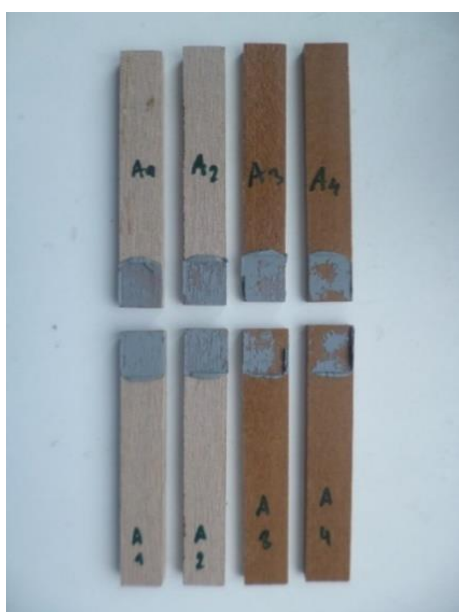
Obr. 25 Přetrhnuté zkušební vzorky lepené lepidlem Auratech AR94201
