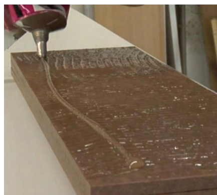
Obr. 6 Lepení materiálu Resysta (SIMONA, 2016)
