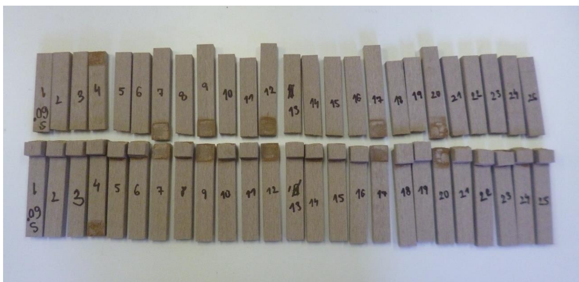
Obr. 57 Vzorky po zkoušce mezního smykového napětí v tahu při teplotě 60 °C – svařený spoj
