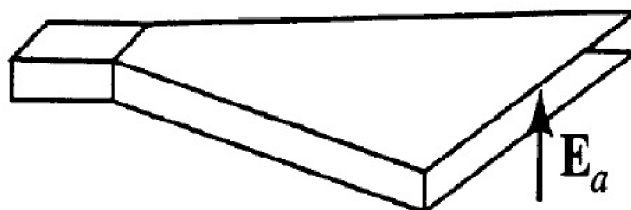
Obr. 3.10: Vyobrazení sektorové trychtýřové antény vyzařující v H-rovině [21]
