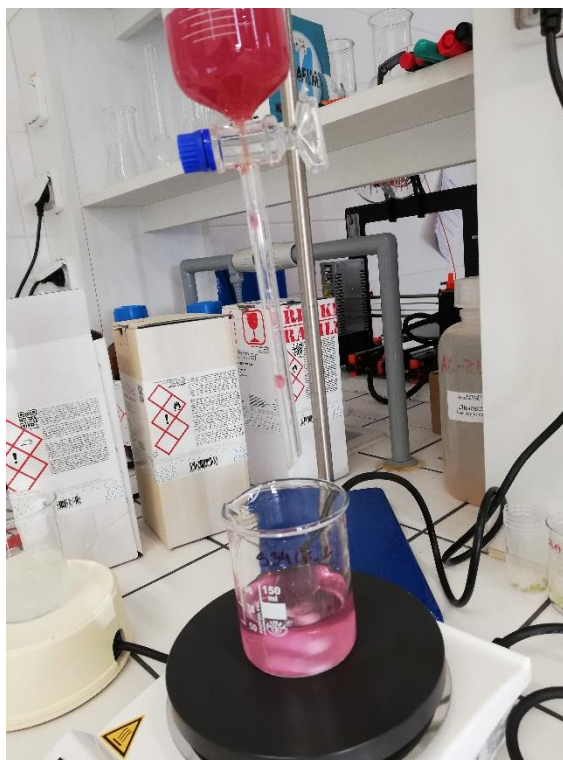
Obr. 7: Průběh smíchávání kyseliny šťavelové a roztoku s kationty \text{Co}^{2+} .
