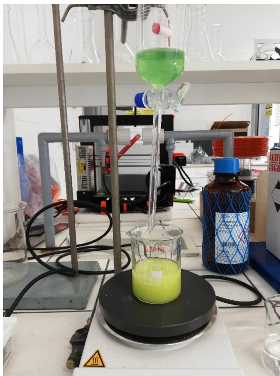
Obr. 5: Průběh smíchávání kyseliny šťavelové a roztoku s kationty \text{Ni}^{2+} a \text{Fe}^{2+} .
