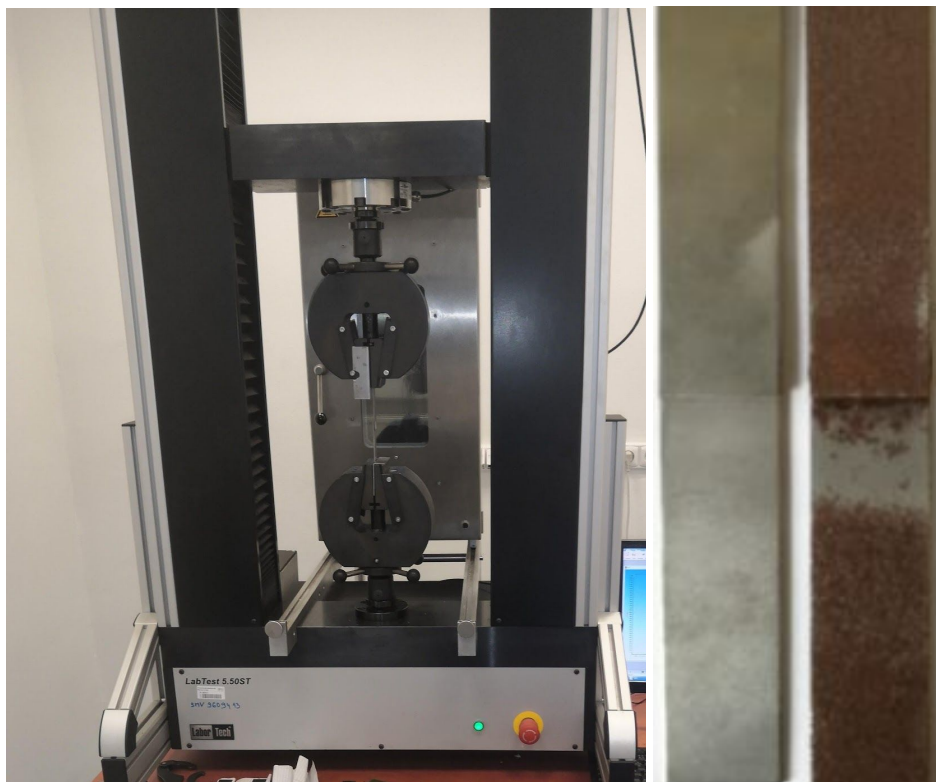
Obr. 31 Univerzální zkušební stroj LabTest (vlevo), zkušební tělesa před a po působení degradace (vpravo)
