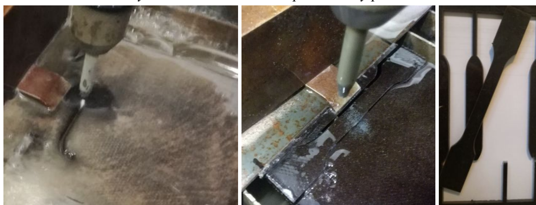
Obr. 28 Výroba zkušebního tělesa pro zkoušky pevnosti v tahu
