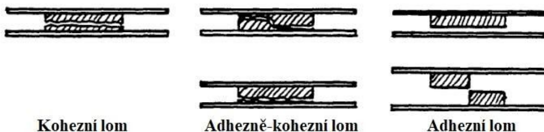
Obr. 25 Základní typy porušení lepeného spoje
