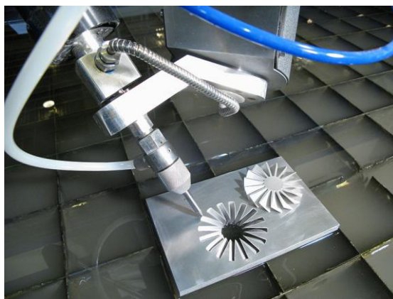
Obr. 13. Aplikácia 5-osého AJM obrábania 24
