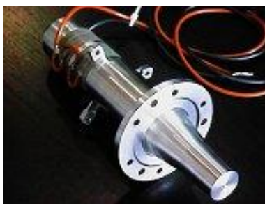
Obr.4 Nástroj pre obrábanie ultrazvukom 9
