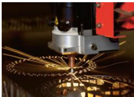
Obr.8 Vysokorýchlostné dierovanie laserom 13
