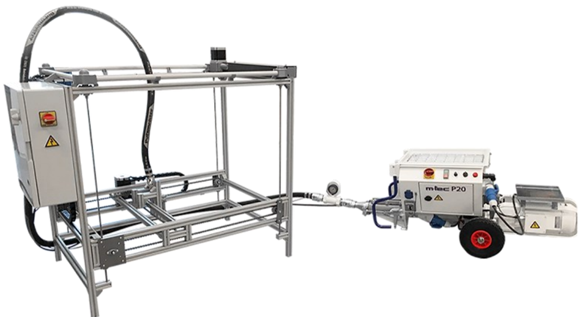
Obr. 15 Konstrukce tiskárny Constructions-3D MiniPrinter EDU [15]
