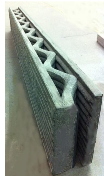
Obr. 2 Vlnitá struktura CC [2]
