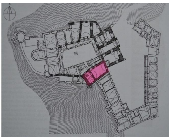
19. Frýdecký zámek, Frýdek – půdorys zámku se zvýrazněnou nejstarší gotickou fází 14. století, jižní křídlo zámku
