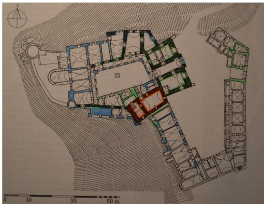
18. Frýdecký zámek, Frýdek – půdorys se zvýrazněnými jednotlivými částmi stavebních etap: červeně – gotická fáze 14. století, zeleně – pozdní gotika 15. století, modře – renesance Bruntálských z Vrbna, přelom 16. – 17. století
