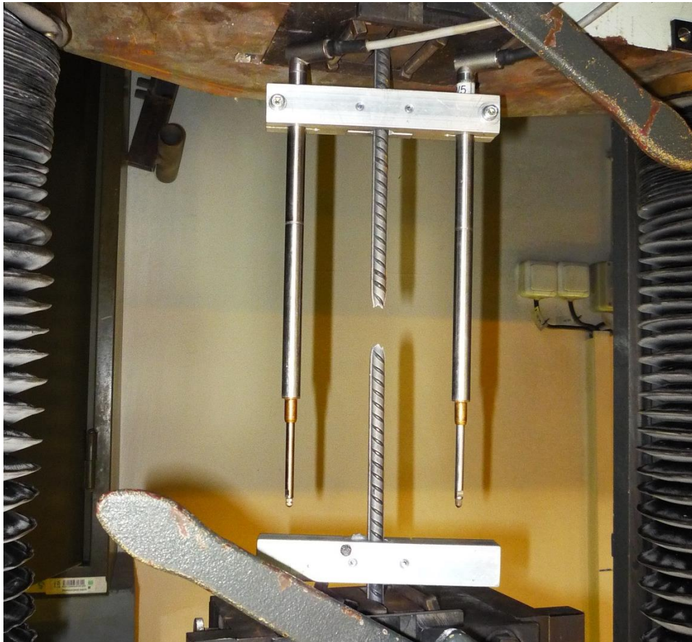
Obr. 1.6 Zkouška oceli v tahu (výztuž \varnothing 6\text{mm} )
