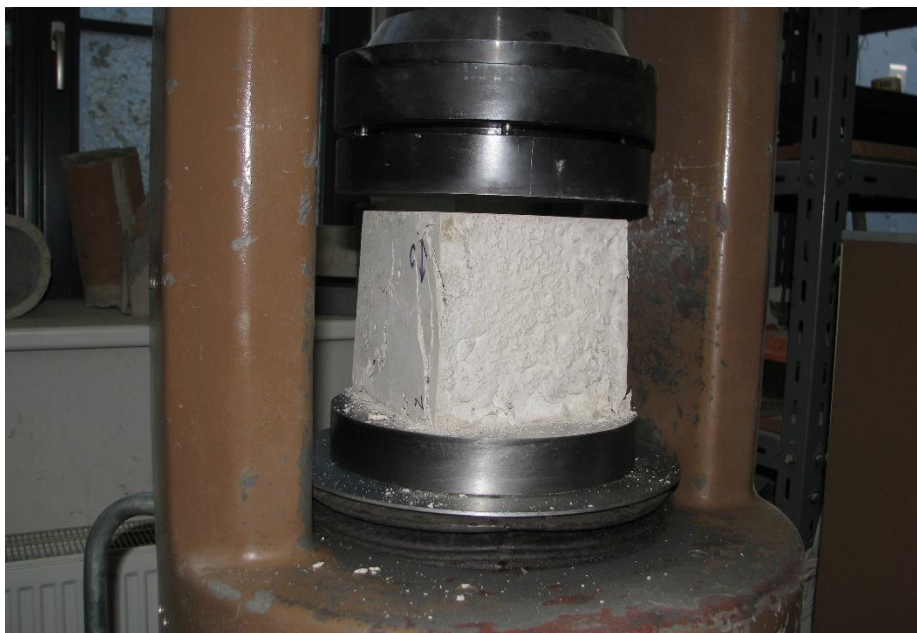
Obr. 1.1 Zkouška pevnosti tlaku betonu
