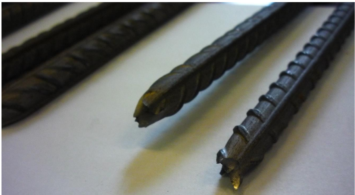
Obr. 1.7 Přetržená zkoušená výztuž
