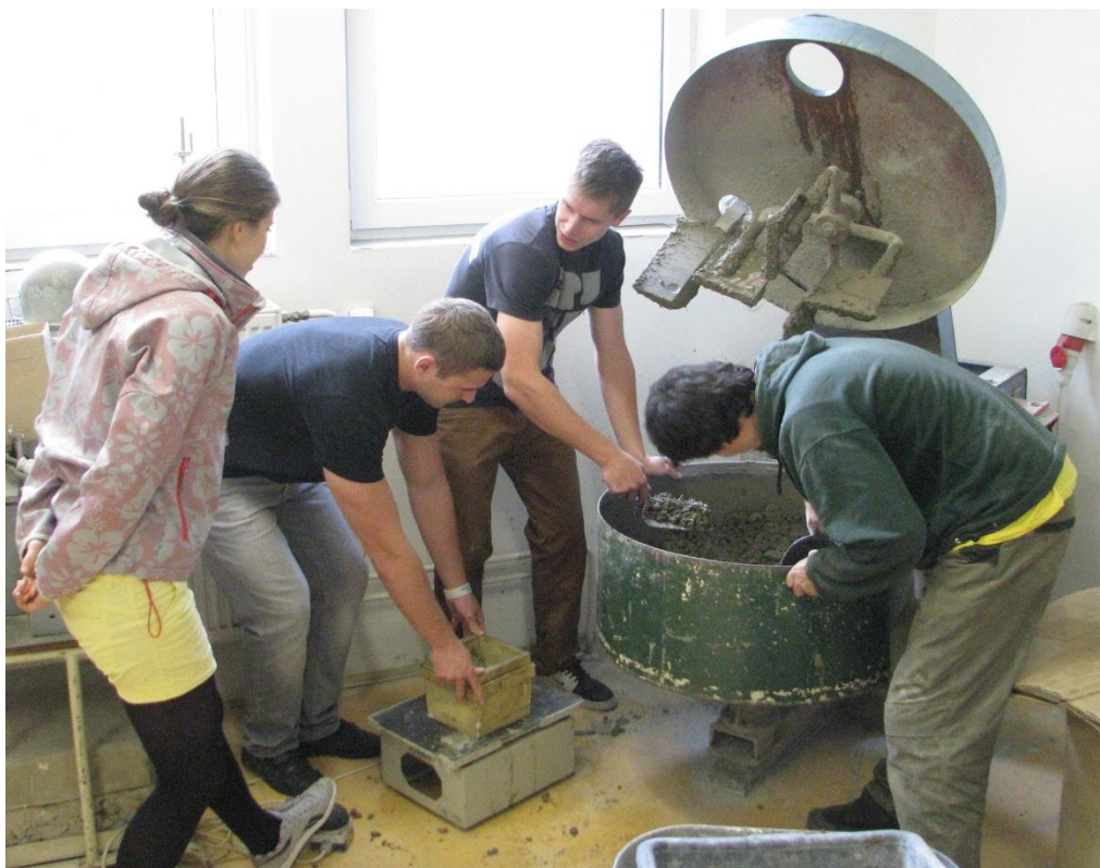
Obr. 2.9 Výpomoc při betonáži doprovodných těles
