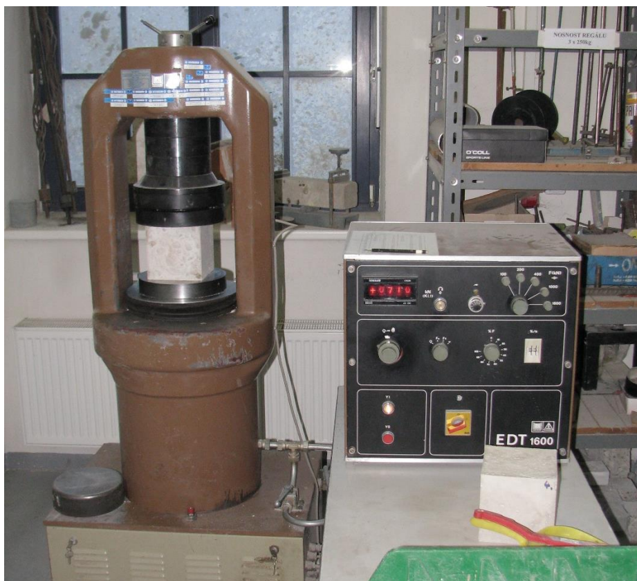
Obr. 1.2 Laboratorní lis, zkouška krychelné pevnosti v tlaku
