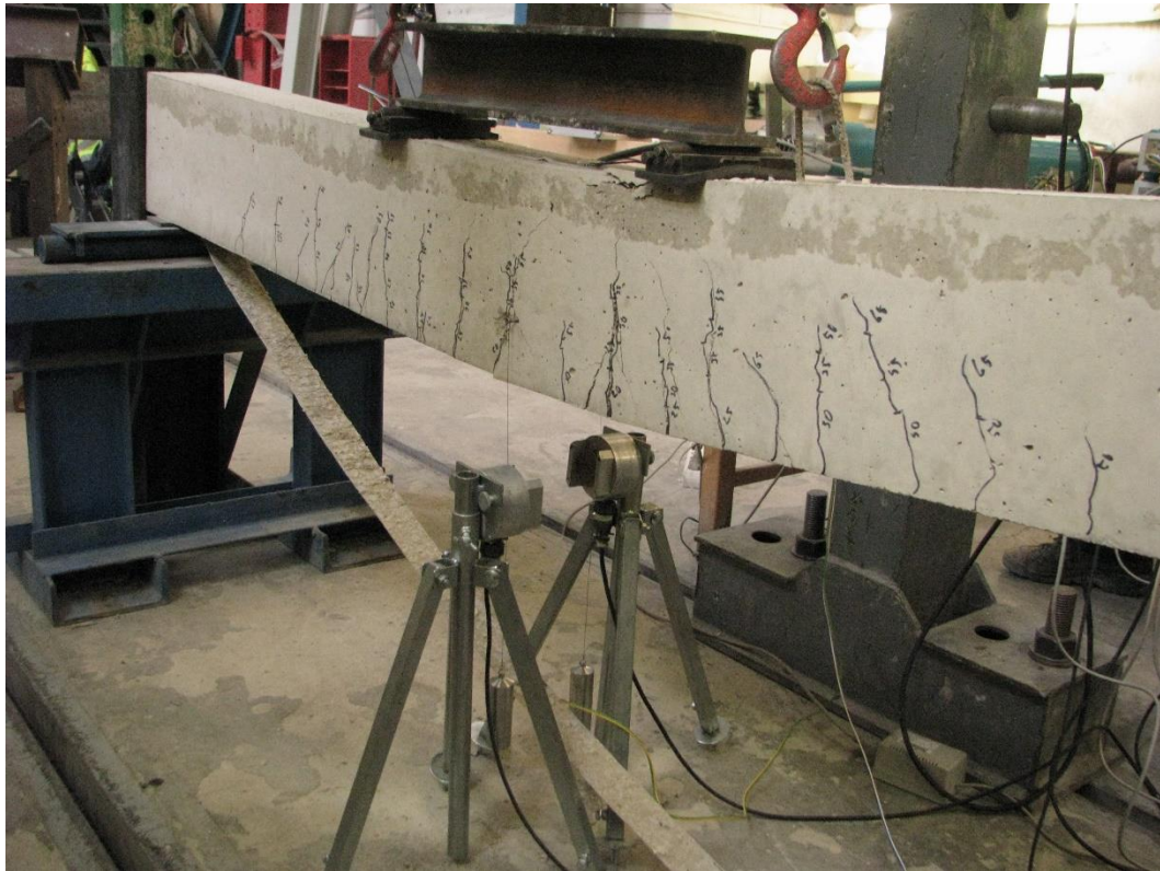
Obr. 2.29 Trhliny po odtržení lepené výztuže
