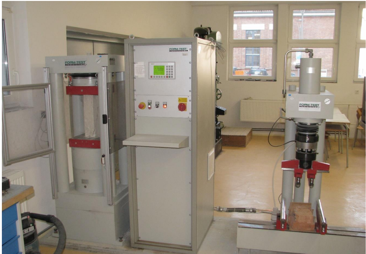
Obr. 1.3 Zkouška hranolové pevnosti betonu v tlaku
