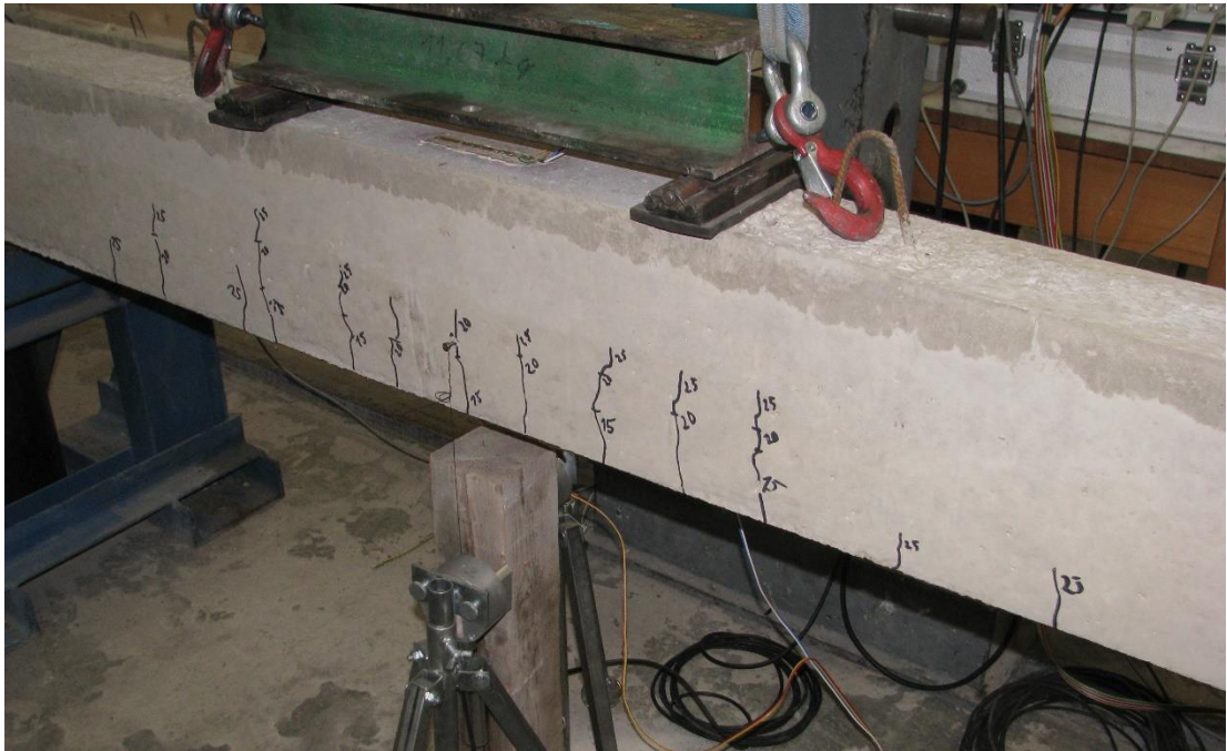
Obr. 2.17 První trhliny v tažené oblasti trámce
