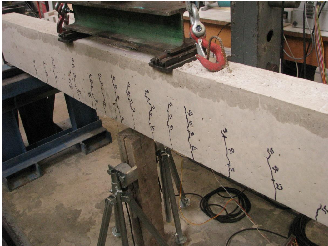
Obr. 2.19 Rozšiřování stávajících trhlin
