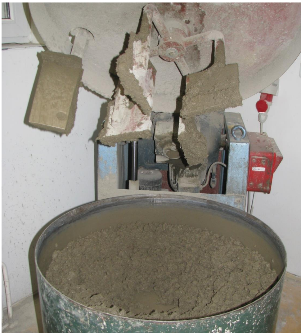
Obr. 2.5 Příprava čerstvé betonové směsi
