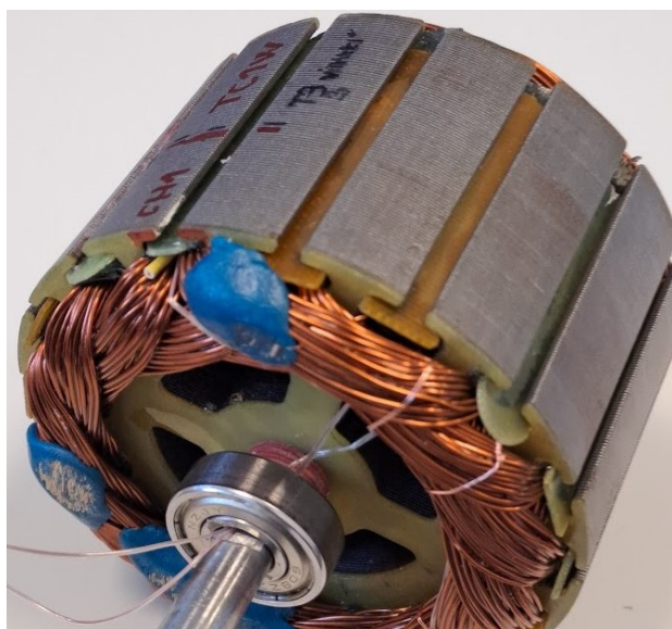
Obrázek 3.25: Rotor osazený termočlánky
