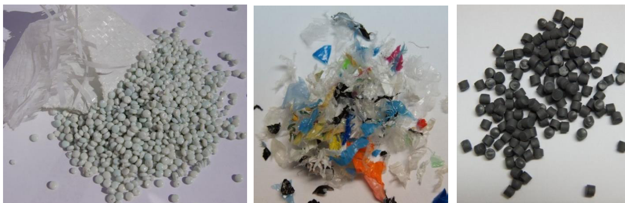
Obrázek 14 Materiál před vstupem do aglomerační linky WIPA DGS a po výstupu
