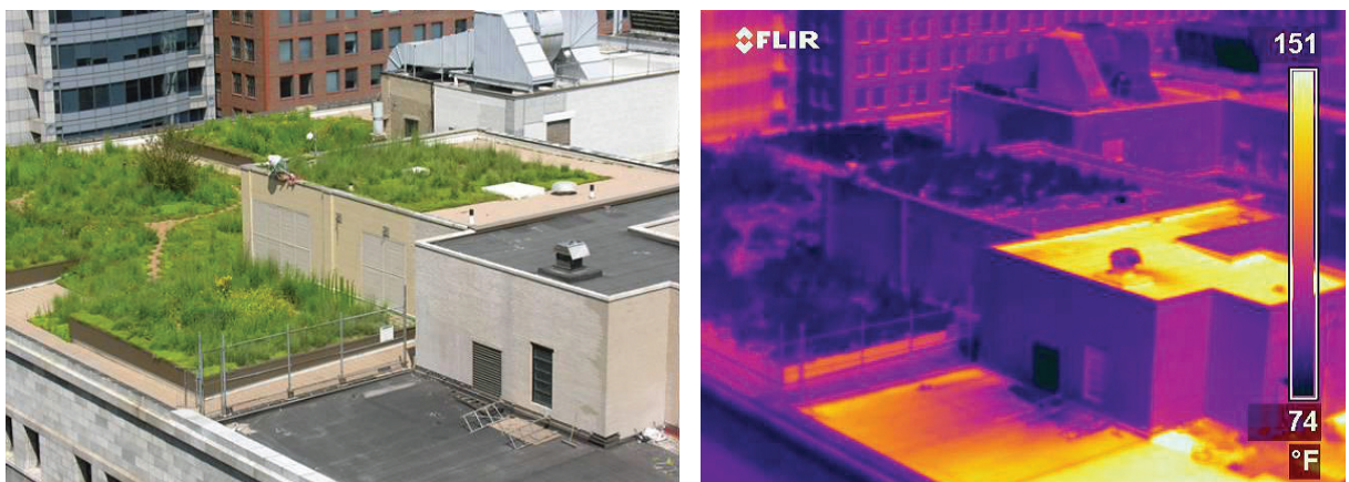
Obr. 6 - Rozdíl v povrchových teplotách zelené a konvenční střechy ( https://webberenergyblog.wordpress.com/2013/04/19/green-infrastructure-and-energy/ )
