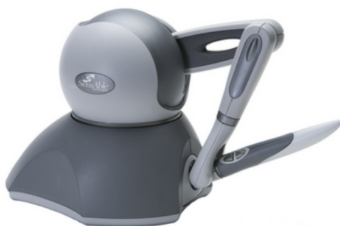
Obrázek 2.10: Haptický skener Phantom Omni (Zdroj [21])
