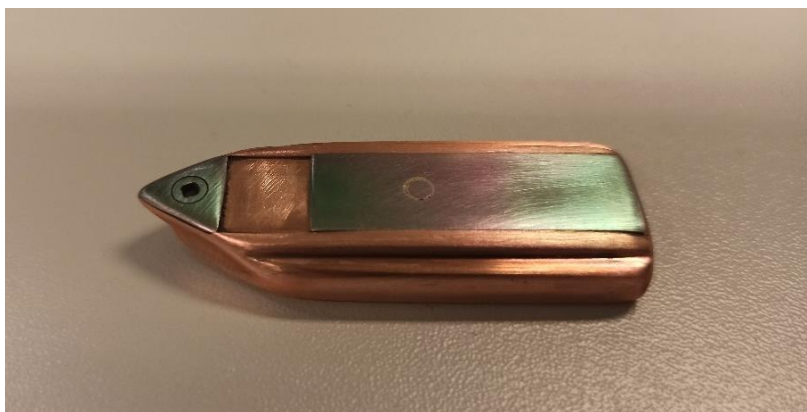
Obr. 24: Držák na upevnění plošných substrátů (tzv. lodička)
