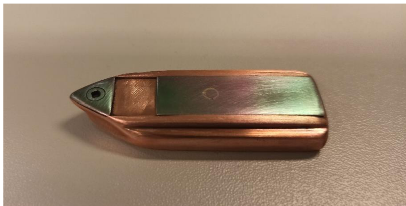
Obr. 24: Držák na upevnění plošných substrátů (tzv. lodička)
