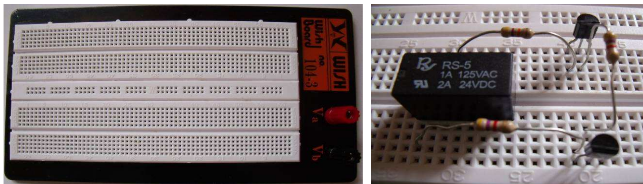
Obr. 27 Vlevo propojovací pole, vpravo detail zapojení součástek na propojovacím poli
