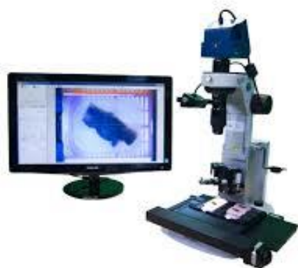
Obr. 11: Semi-automatický přístroj na tvorbu TMA bloků (URL:< http://parsgene.com > [cit. 2016-01-02]).
