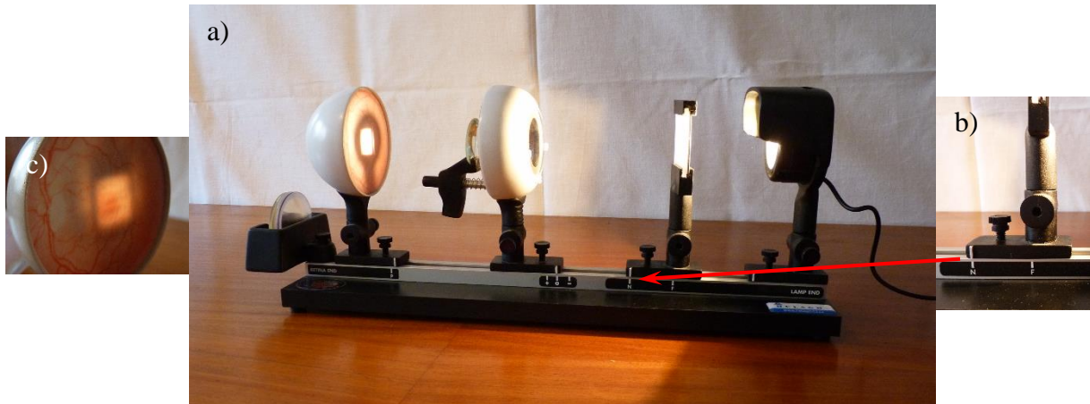
Obrázek č. 47: Rozložení modelu pro demonstraci blízkého bodu emetropického oka (a) s detailním pohledem na polohu diapozitivu (b) a výsledným obrazem promítaným na sítnici (c)
