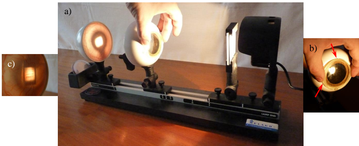
Obrázek č. 57: Rozložení modelu pro demonstraci astigmatismu (a), detail přední části segmentu oka se dvěma na sebe kolmými žlutými torickými čočkami (b) a výsledný obraz vzniklý na sítnici (c)
