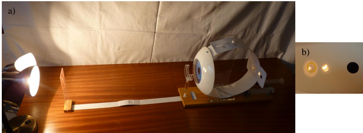
Obrázek č. 31: Rozložení modelu pro demonstraci žluté a slepé skvrny komorového oka (a) s detailním pohledem na sítnici (b) – krok 1 foto v měřítku: 1:2
