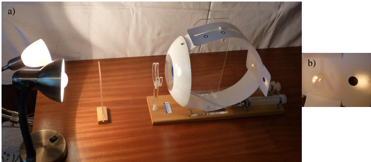
Obrázek č. 33: Rozložení modelu pro demonstraci žluté a slepé skvrny komorového oka (a) s detailním pohledem na sítnici (b) – krok 1 foto v měřítku: 1:2
