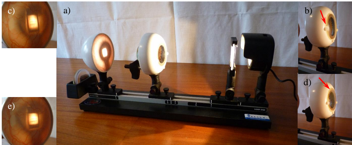
Obrázek č. 56: Rozložení modelu pro demonstraci astigmatismu (a), detail přední části segmentu oka se žlutou torickou čočkou ve dvou polohách (červená šipka; b, d) a výsledný obraz vzniklý na sítnici (c, e)
