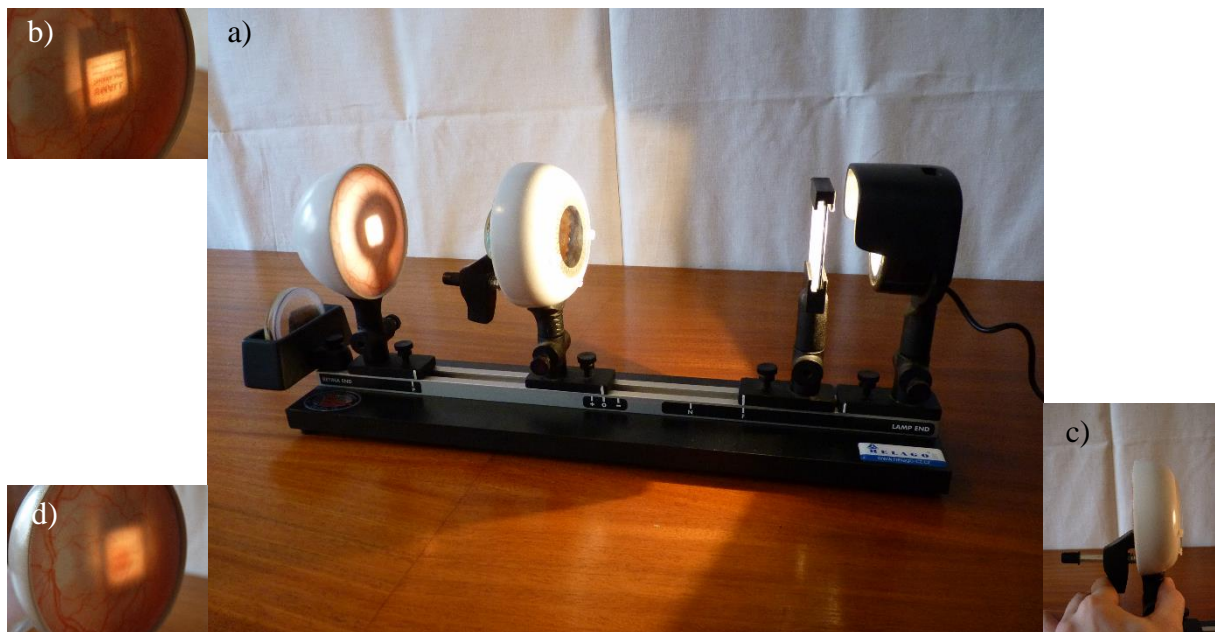
Obrázek č. 46: Rozložení modelu pro demonstraci akomodace emetropického oka (a) s detailním pohledem na výsledný obraz promítaný na sítnici (b) a simulace akomodace (c) s výsledným obrazem promítaným na sítnici (d)
