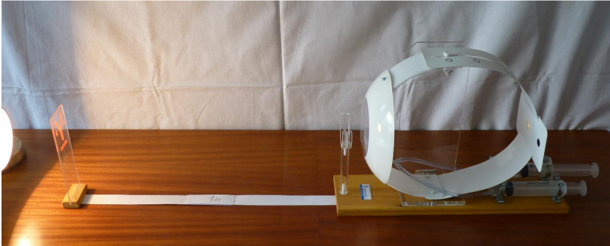
Obrázek č. 40: Rozložení modelu pro demonstraci korekce myopie přiblížením tabulky s písmeny – krok 3a foto v měřítku: 1:2
