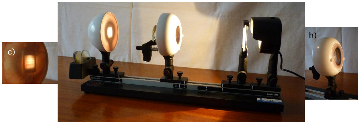
Obrázek č. 55: Rozložení modelu pro demonstraci korekce myopické oční vady (a) s detailem růžové (konkávní) čočky (b) a obrazem promítaným na sítnici (c)
