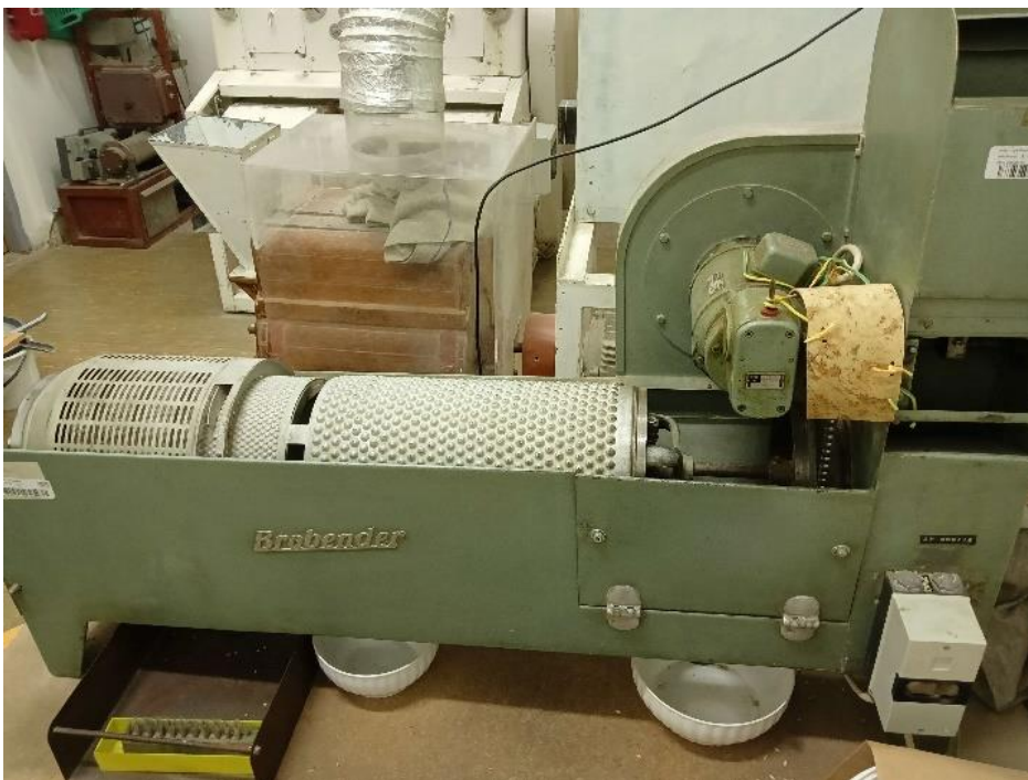
P7: cyklónový mlýn s rotorem a prstencem
