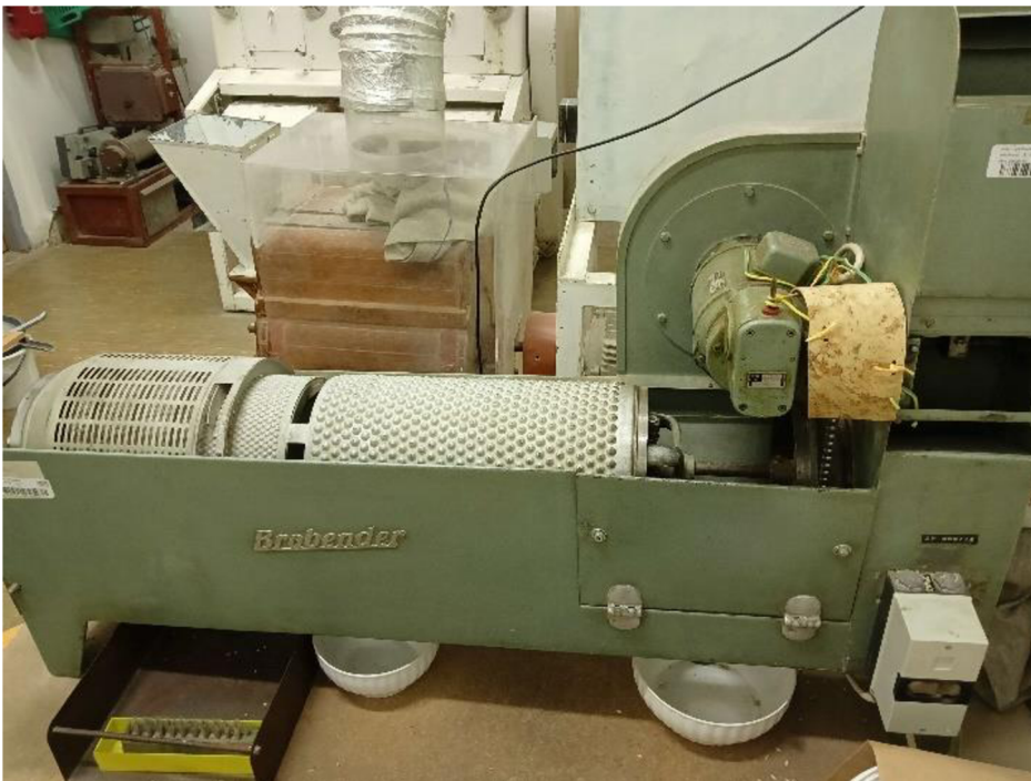
P7: cyklónový mlýn s rotorem a prstencem
